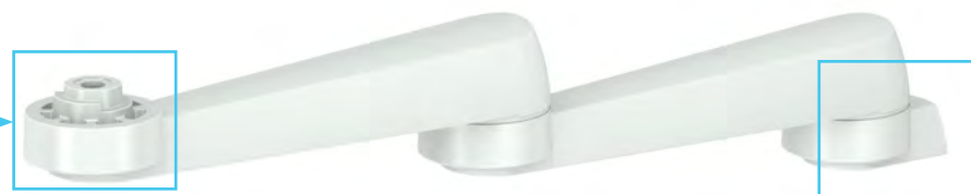
Schwenkarm rm-port, 2-fach verfügbare Auslegerlängen: 250 mm + 250 mm und 325 mm + 325 mm
