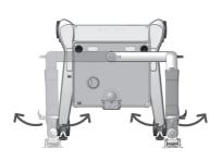
Posición de trabajo derecha / izquierda Brazo giratorio bloqueado Sujeción flexible desbloqueado
